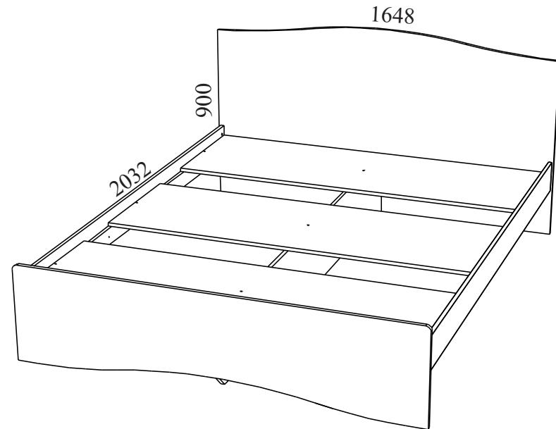
Габаритные размеры: длина - 1648 мм, высота - 900 мм, глубина - 2032 мм.
