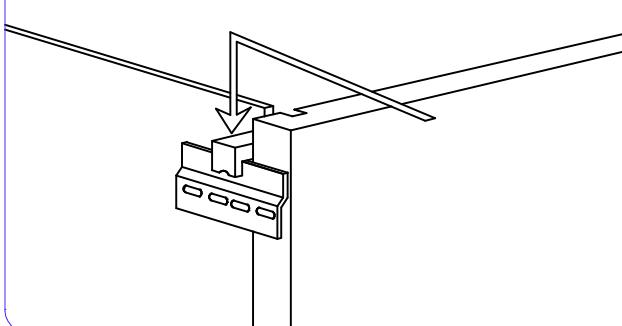
**Установка задней стенки**
